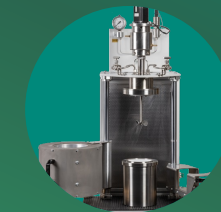
Корзины реактора высокого давления
